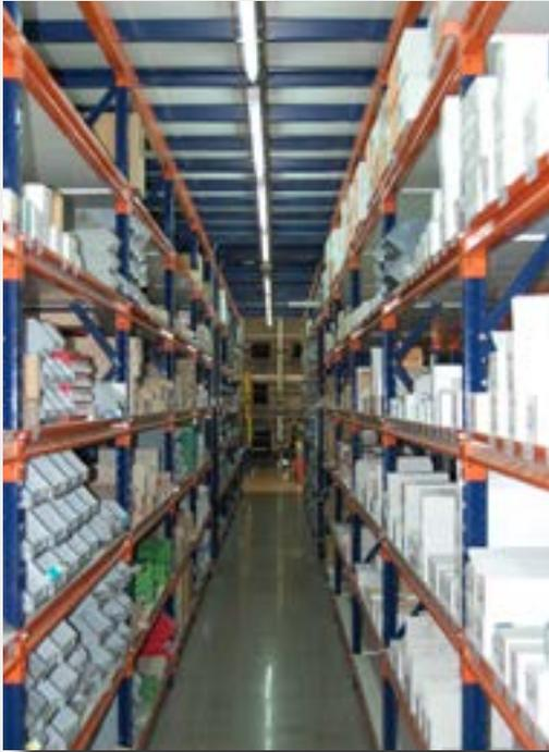
La estantería para carga manual está especialmente diseñada para el almacenamiento de todo tipo de material, con gran cantidad de referencias, mucha rotación y peso no muy elevado.
